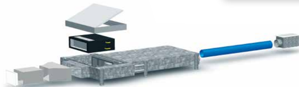
3: Intégration des composants AIRBOX®, INSTABOX™ et WESCO SYS (gaine de distribution)
