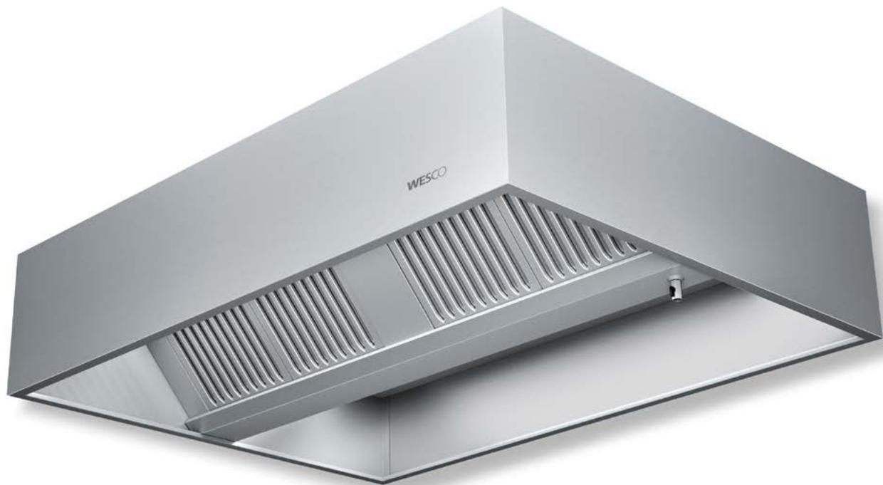
Suchen Sie ein effizientes Insel-Sauggehäuse für den Einsatz im Gastrobereich, ist die FFG gusto genau richtig für Sie. Der grosse Stauraum erfasst aufsteigende Kochdünste besonders effektiv. Die beidseitig schräg gestellten Labyrinthfilter aus Edelstahl filtern das Fett und führen es in eine hermetische Fettfangrinne. Einfach in der Reinigung, ist die FFG gusto eine effiziente Lösung für hohe Anforderungen.
