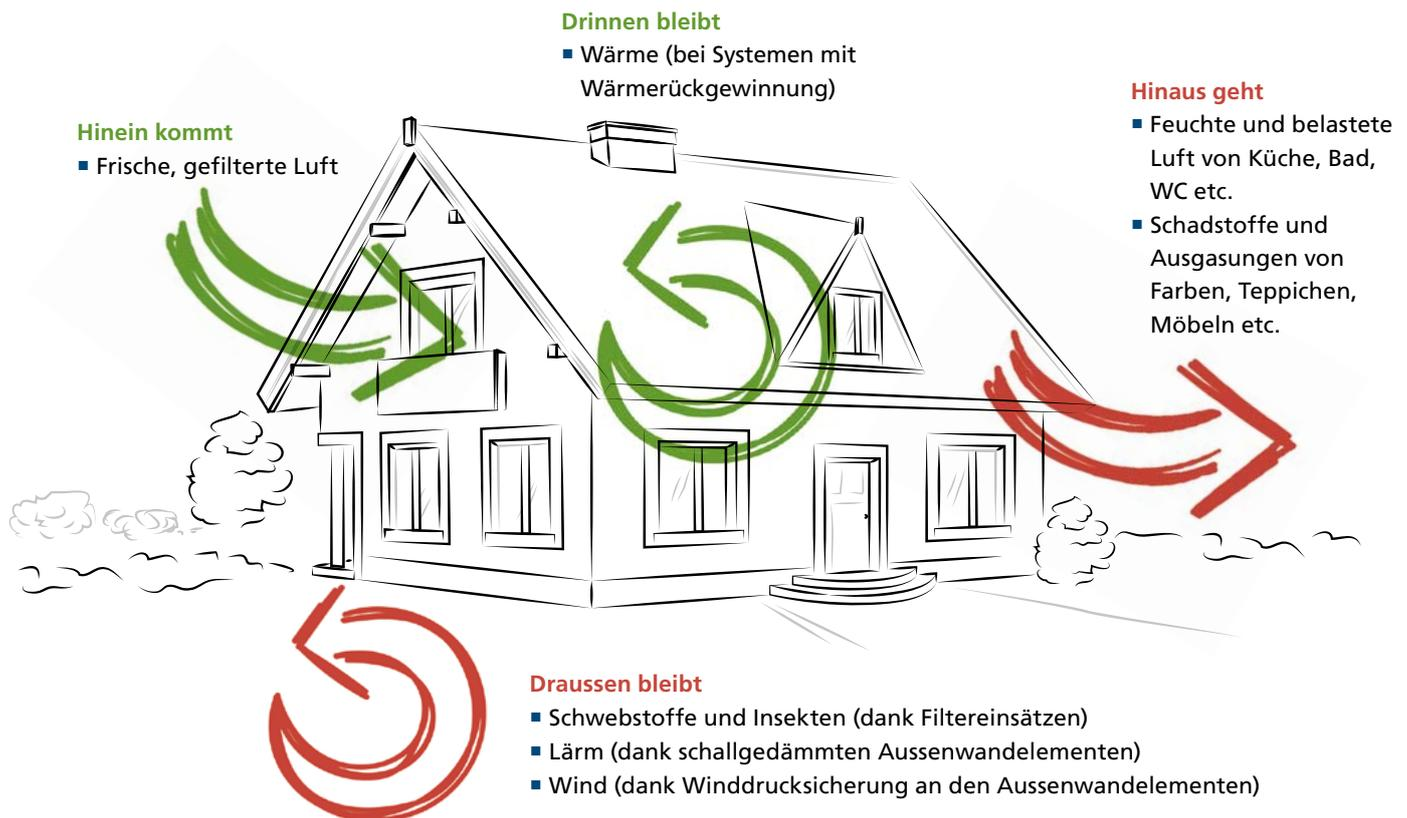
Die Vorteile einer kontrollierten Wohnungslüftung liegen auf der Hand: gleichbleibende Raumluftqualität den ganzen Tag und die ganze Nacht hindurch, und das bei geschlossenen Fenstern.
