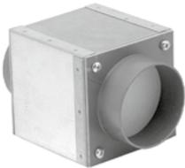
**Geruchsdichte Rückstauklappe RSD, mit 2 Stützen, selbsttätig, passend auf WESCO und Fremdprodukte.** Verhindert Geruchsübertragungen, wenn mehrere Abzugshauben an einen Abluftkanal angeschlossen sind. Verbindungsrohr separat bestellen. Muss vertikal eingebaut werden.
