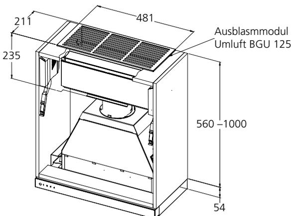
**Einbaubeispiel: scharnierte Türen, Schrankhöhe = 500 mm (max. 900 mm)**
