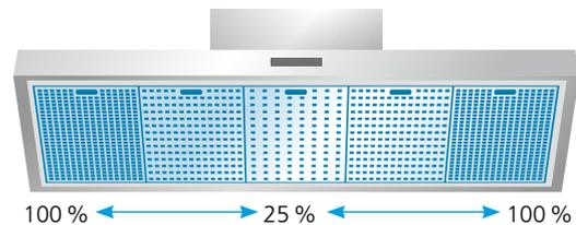
Filter strömungsoptimiert: Fettfilter mittig unter dem Ventilator ist fast geschlossen, gegen den Rand hin sind sie offener und strömungsdurchlässiger. (je höher die % Zahl desto luftdurchlässiger der Fettfilter)
