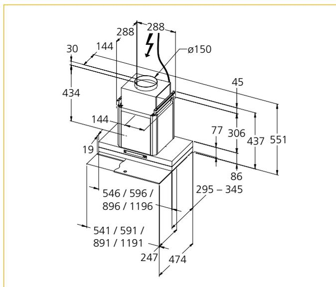
**Einbauvariante Abluft oben, unten bündig**
