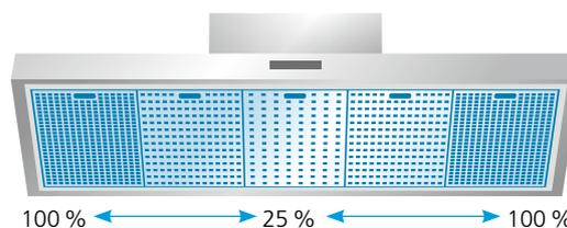
Filter strömungsoptimiert: Fettfilter mittig unter dem Ventilator ist fast geschlossen, gegen den Rand hin sind sie offener und strömungsdurchlässiger. (je höher die % Zahl desto luftdurchlässiger der Fettfilter)
