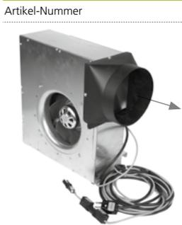
**Einbauventilator mit EC Lüfter für Abluftsysteme mit einer oder mehreren Absaugstellen. Gehäuse und Ventilator aus verzinktem Stahlblech. Einbaulage beliebig, mit Druckstutzen und 4 m Kabel mit Stecker, inkl. 1 Satz Schwingungsdämpfer. Motor mit Kugellagerung. Saugstutzen separat bestellen.**
